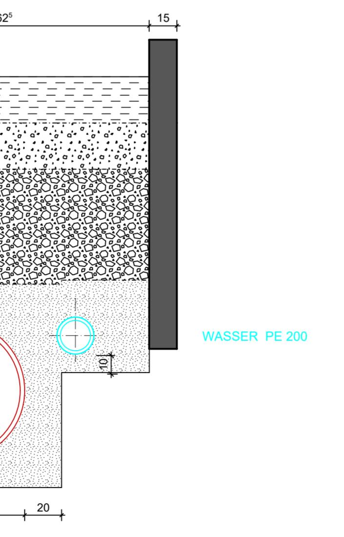
**Kanalisation / Steuerkabel ARA****Grabenprofil 7**
