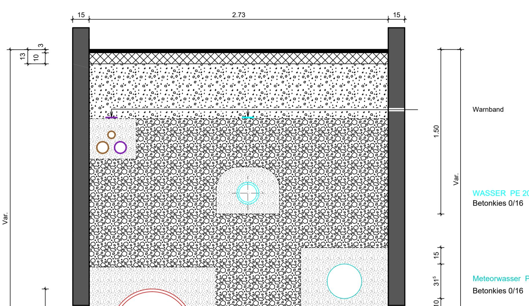
**Kanalisation / Steuerkabel ARA / Beleuchtung / EW / Wasser****Grabenprofil 5**
