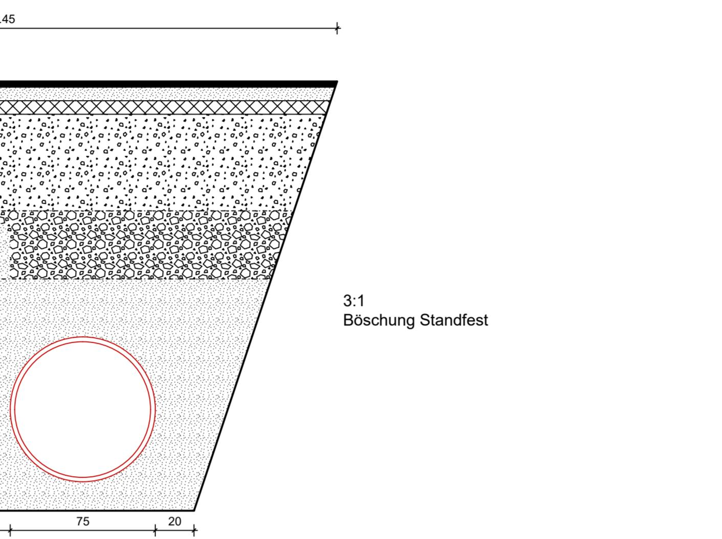
**Kanalisation / Steuerkabel ARA / Beleuchtung / Wasser****Grabenprofil 3**
