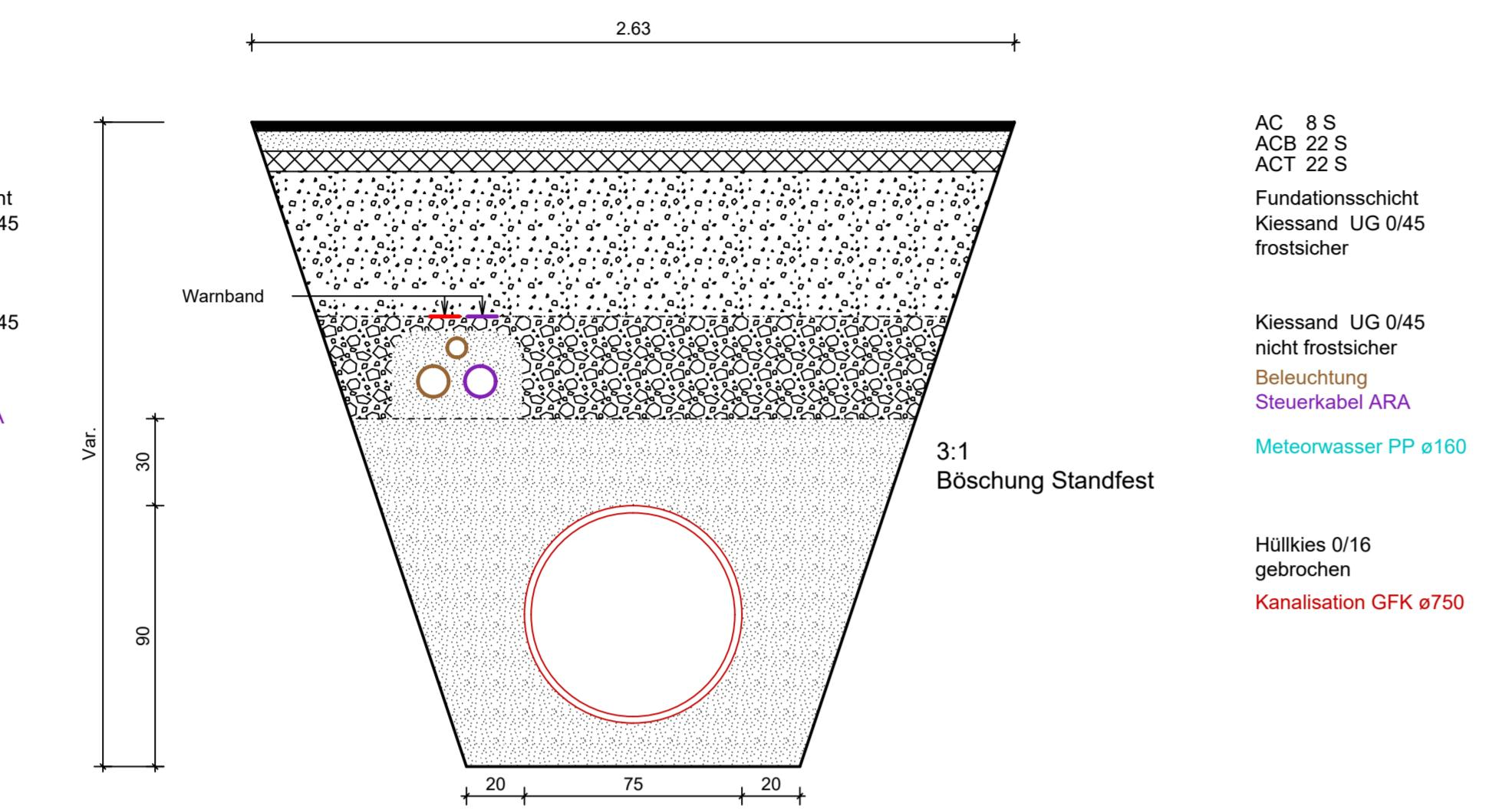
**Kanalisation / Steuerkabel ARA / Beleuchtung / Meteorwasser****Grabenprofil 2**
