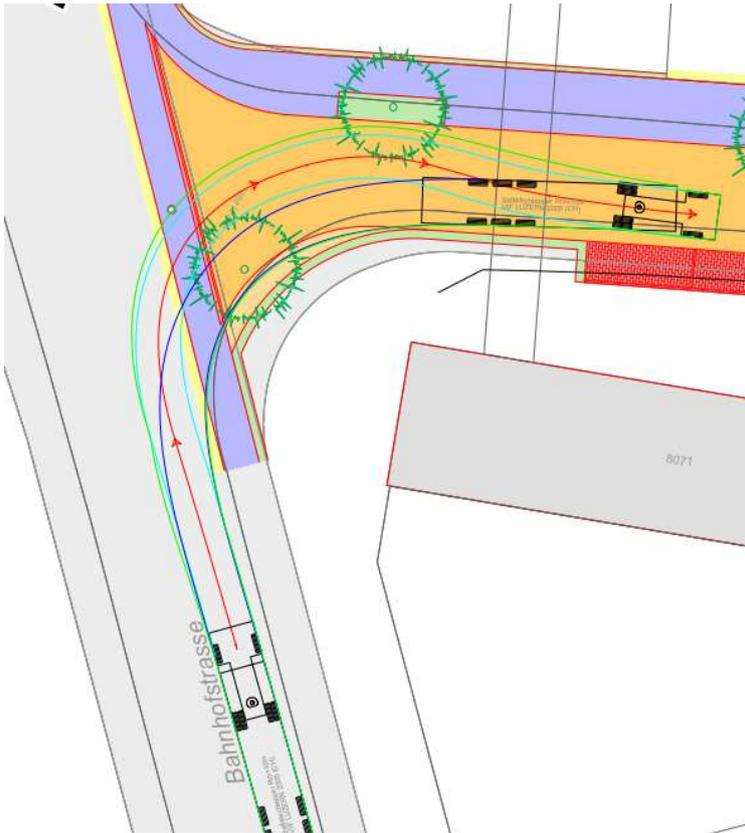
**Abbildung 5: Schleppkurven Einlenker Bahnhofstrasse / Sportstrasse eines Sattelschleppers**
