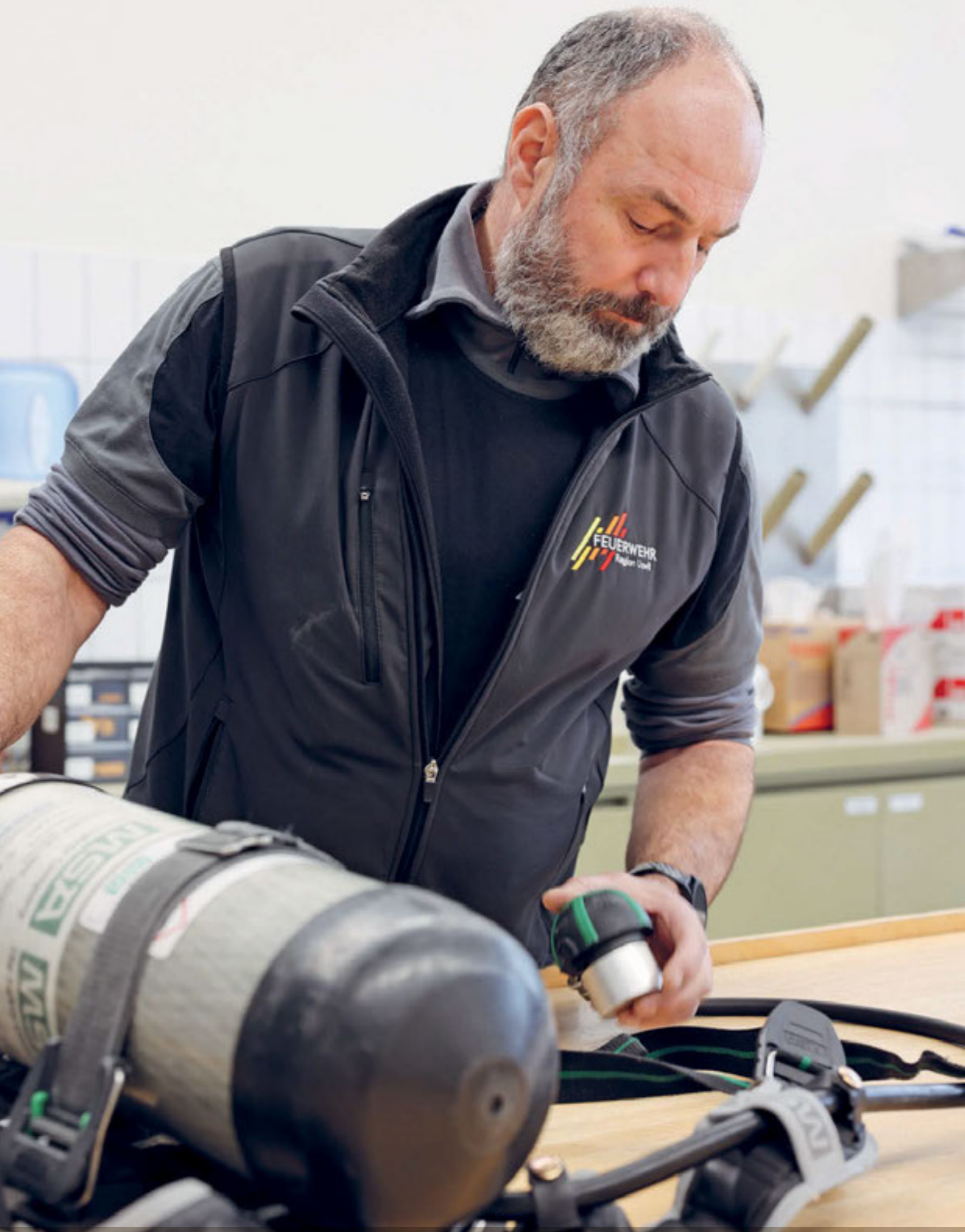
Toni Schmid bei der Retablierung und Kontrolle eines Atemschutzgerätes. Traggestell, Pressluftflasche, Druckminderer, Anschlüsse und Lungenautomat werden nach jedem Einsatz auf Funktionalität geprüft.
