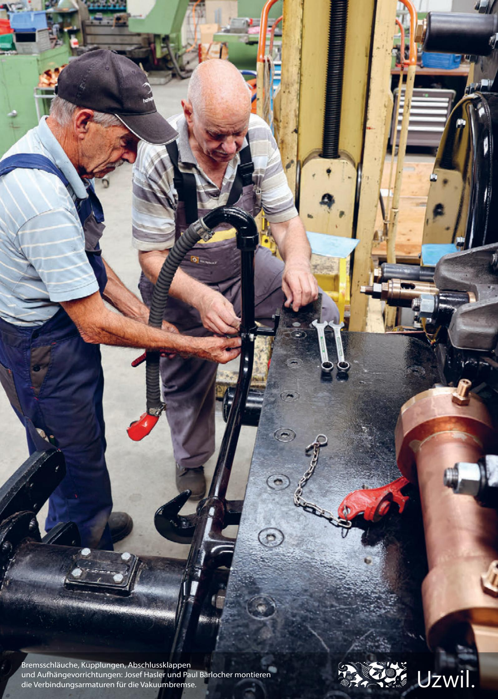
Bremsschläuche, Kupplungen, Abschlussklappen und Aufhängevorrichtungen: Josef Hasler und Paul Bärlocher montieren die Verbindungsarmaturen für die Vakuumbremse.
