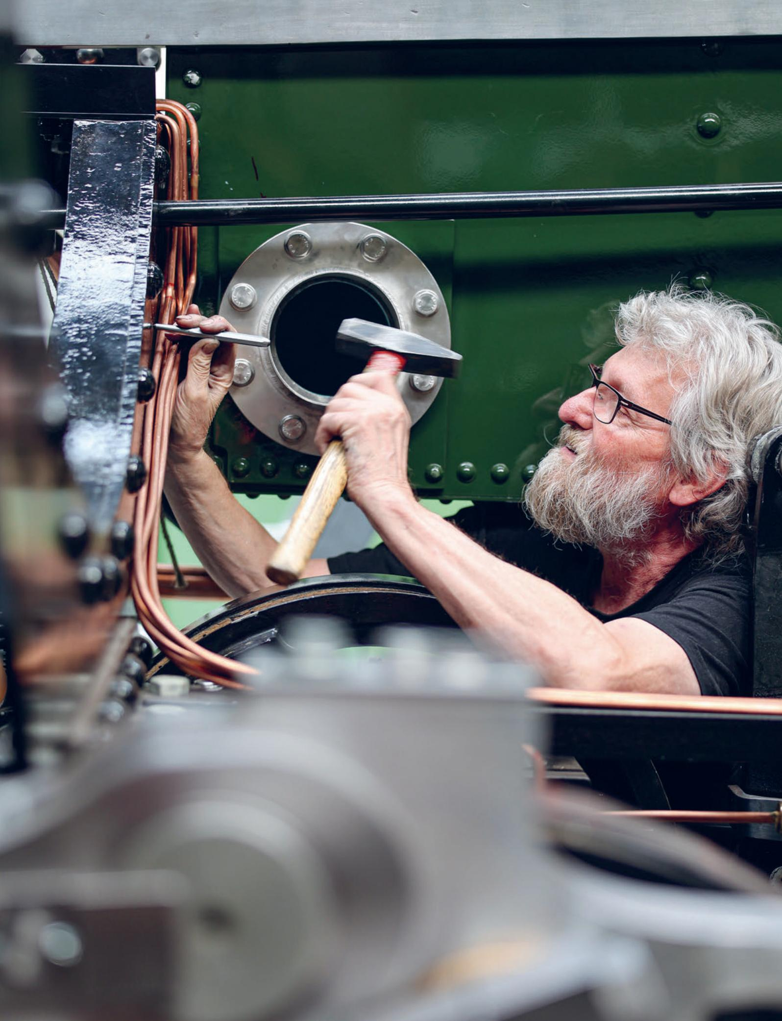
Handwerk pur. Felix Walser markiert mit dem Körner die Positionen, um nachher am richtigen Ort zu bohren und mit Briden die kupfernen Schmierleitungen zu fixieren.
