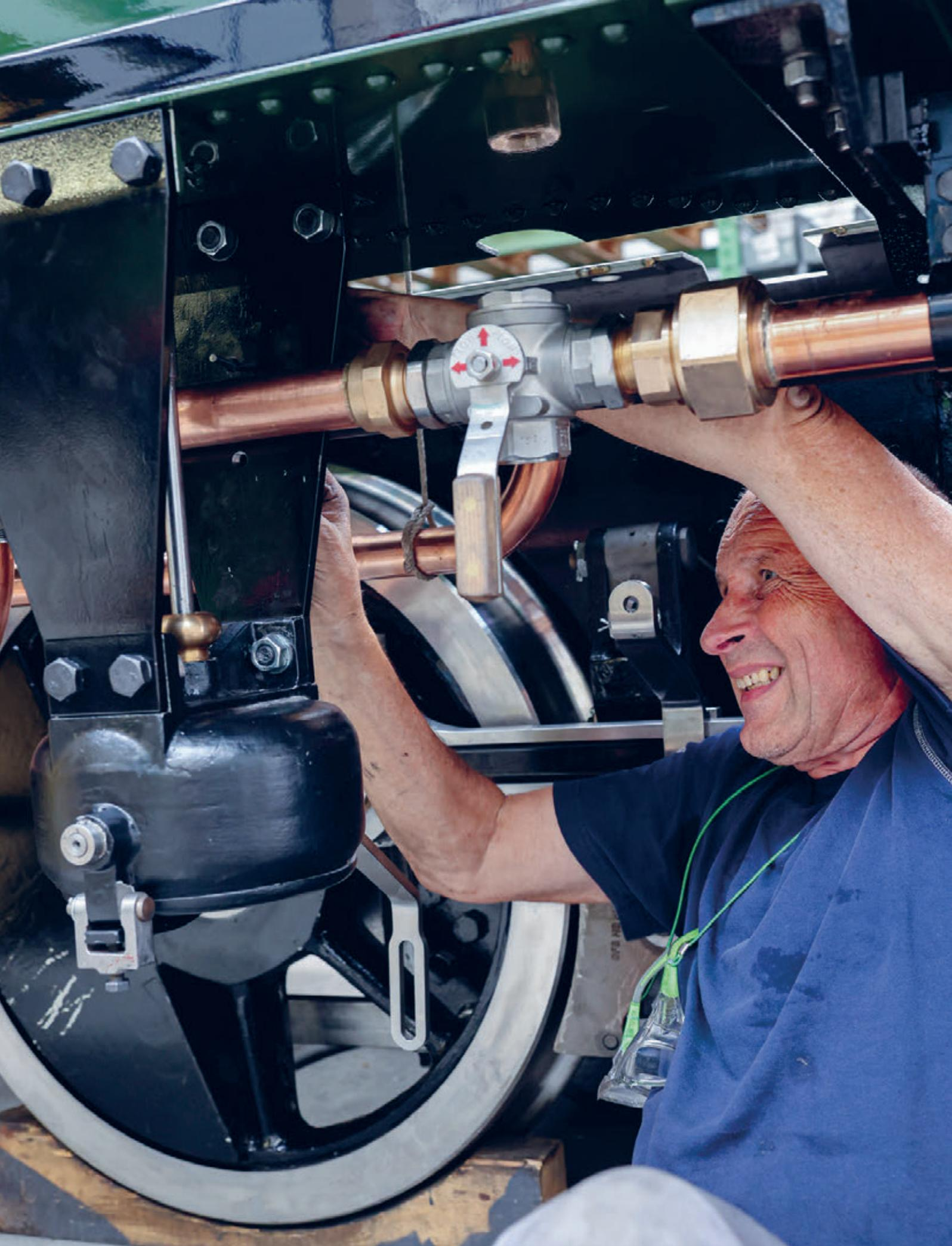
Die freiwilligen Helfer arbeiten mit Engagement und Freude an der Lok. Rolf Lang ist das förmlich anzusehen, auch wenn's anstrengend ist. Er montiert die Kupferrohre für die Kesselwasserspeisung.
