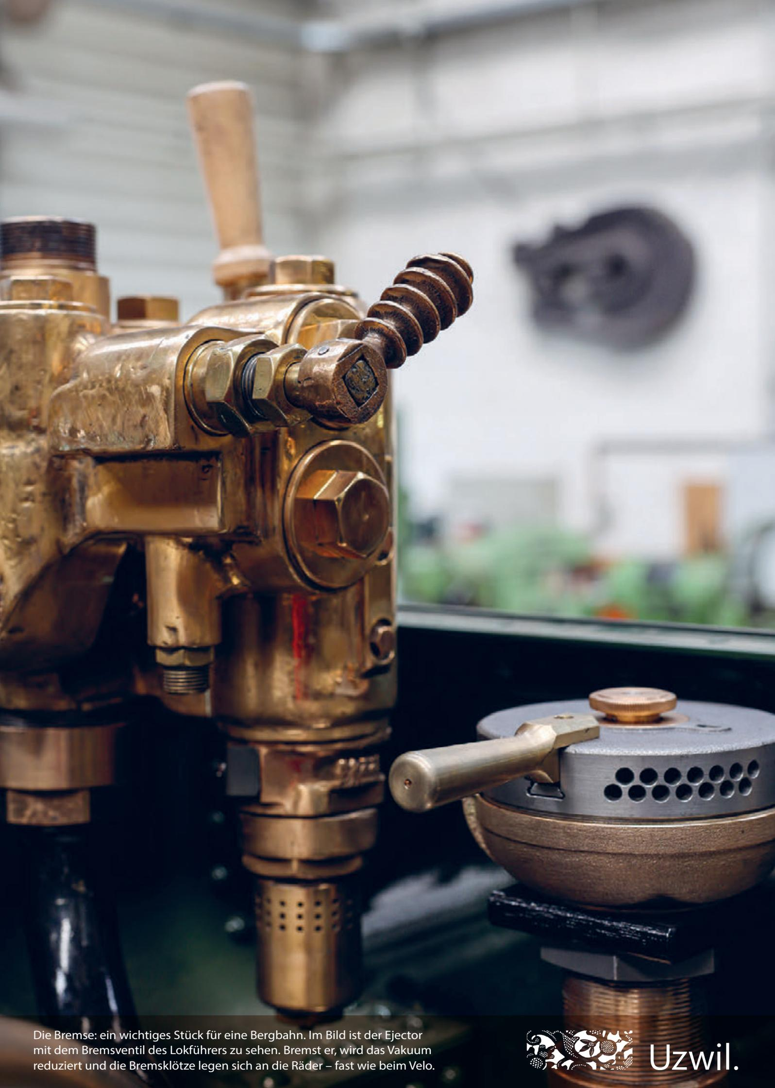
Die Bremse: ein wichtiges Stück für eine Bergbahn. Im Bild ist der Ejector mit dem Bremsventil des Lokführers zu sehen. Brems er, wird das Vakuum reduziert und die Bremsklötze legen sich an die Räder – fast wie beim Velo.
