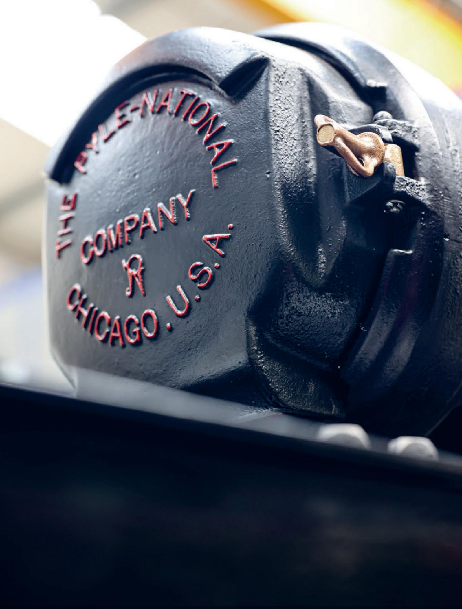
Dieser Dampfgenerator liefert den Strom für die elektrische Beleuchtung der Lokomotive. Während man in Vietnam auf ein französisches Produkt setzte, wurde jetzt ein wartungsärmeres amerikanisches Produkt verbaut.
