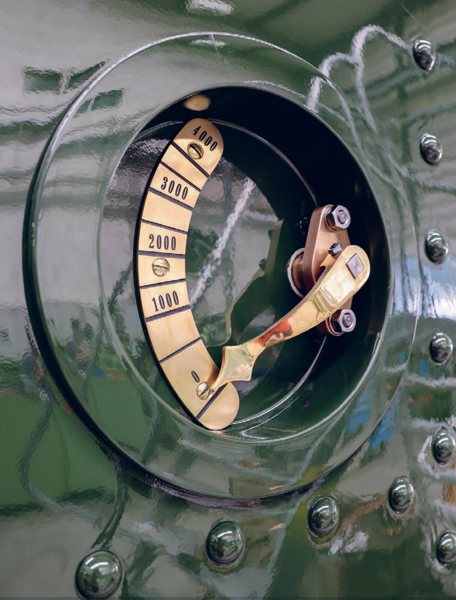
An der Lok Nr. 708 sind noch 45 Prozent der Teile original. Mehr als die Hälfte musste nach der Rückschaffung aus Vietnam neu hergestellt werden. So auch der Wasserkasten und diese äusserst schicke Wasserstandsanzeige.
