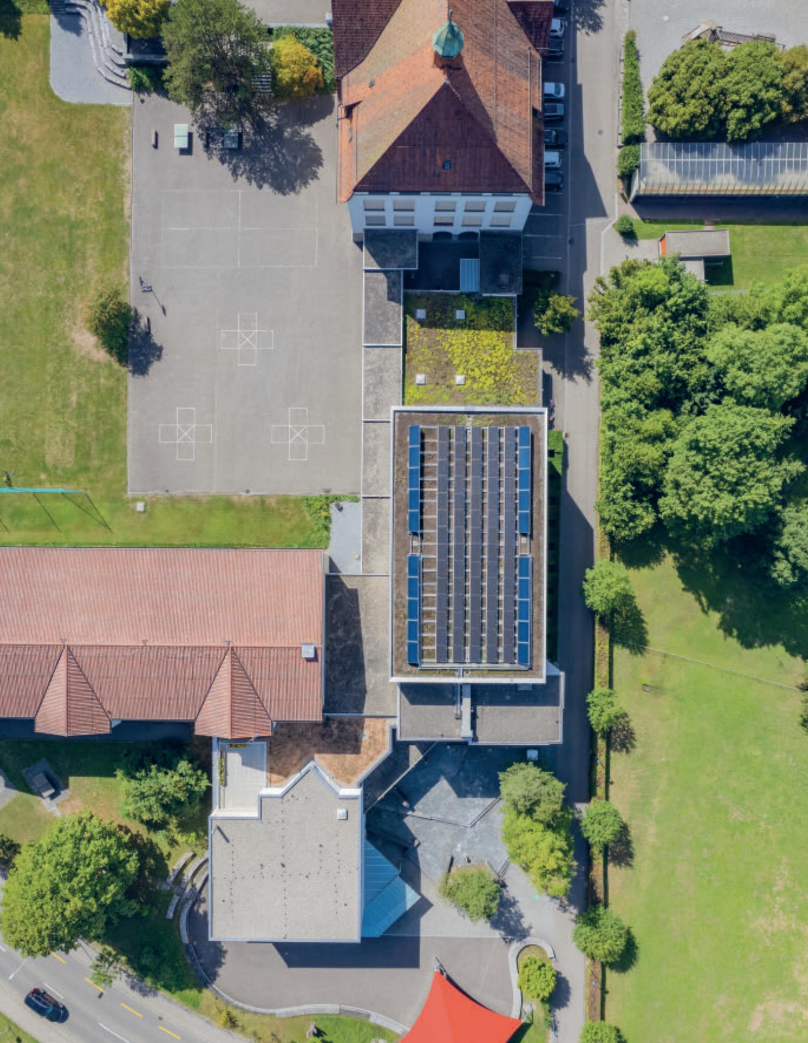
Das historisch bedeutende Schulhaus an der Kirchstrasse 4 erhält aus Gründen der Baukultur keine Photovoltaik-Anlage (vgl. Seite 53/54). Genutzt wird hingegen seit 2014 das Dach der Turnhalle. Die Anlage dort hat eine Leistung von 18,4 Kilowatt-Peak. Potenzial besteht noch auf dem Steildach der Uzeschuel.
