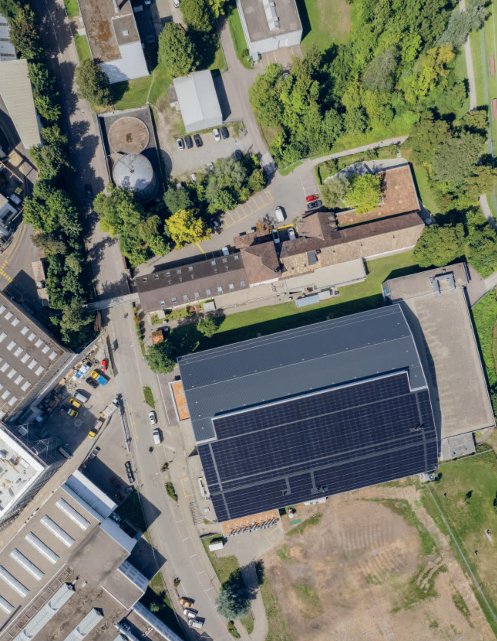
Die Uzehalle ist frisch saniert und energetisch optimiert – sie bleibt eine energieintensive Einrichtung. Die Photovoltaik-Anlage ist mit 418,29 Kilowatt-Peak die leistungsstärkste im Besitz der Gemeinde. Sie dient der Eishalle, der Curlinghalle und der Badi. Eine ähnliche Leistung wird die Anlage auf dem geplanten Werkhof (vgl. Seite 36) haben.
