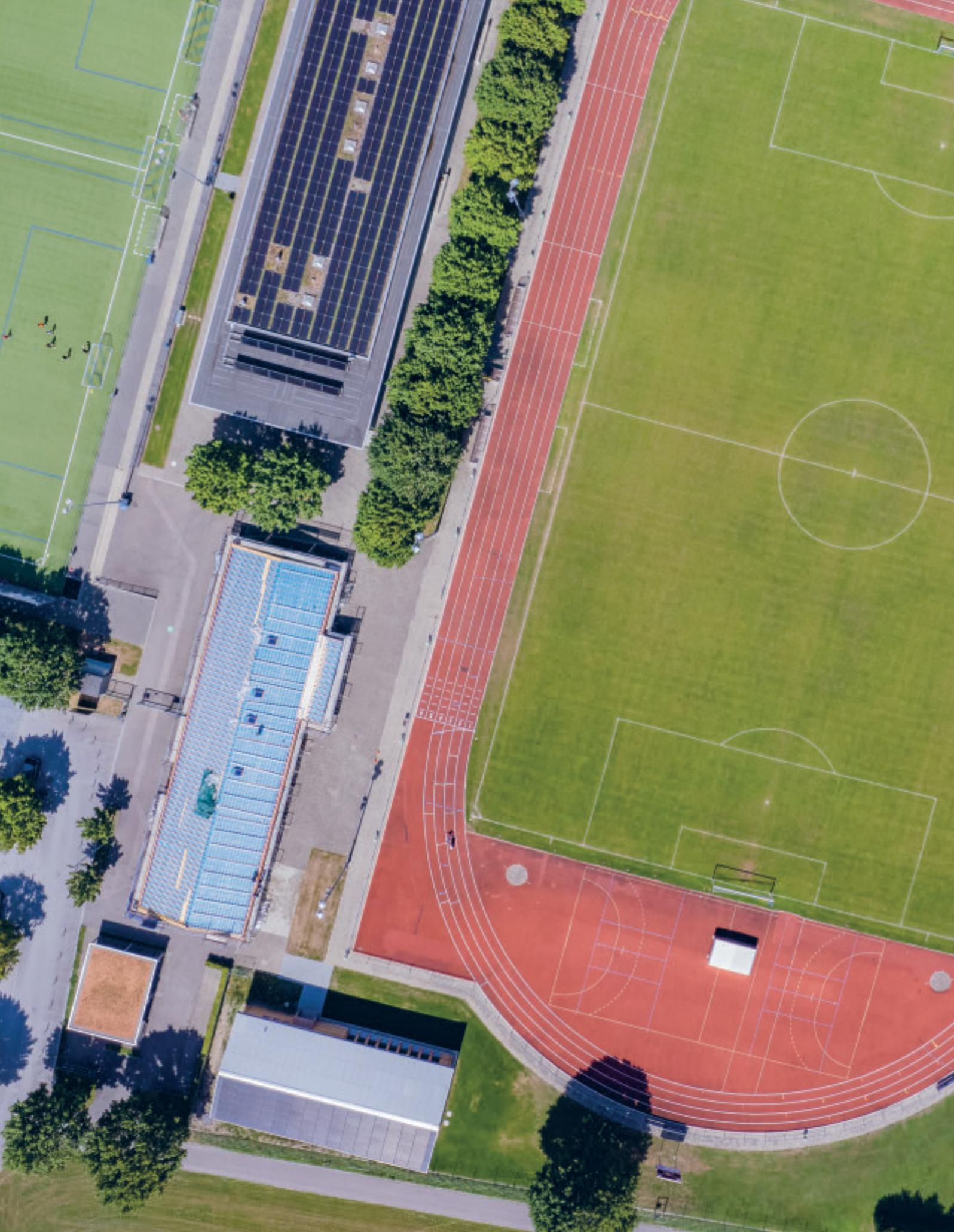
Inzwischen ist die Anlage auf der grossen Garderobe in der Rütli nicht mehr allein. Im Jahr 2020 entstand die Indach-Photovoltaik-Anlage auf der Schwinghalle (29,7 Kilowatt-Peak), 2022 diejenige auf der alten Garderobe (59,2 Kilowatt-Peak).
