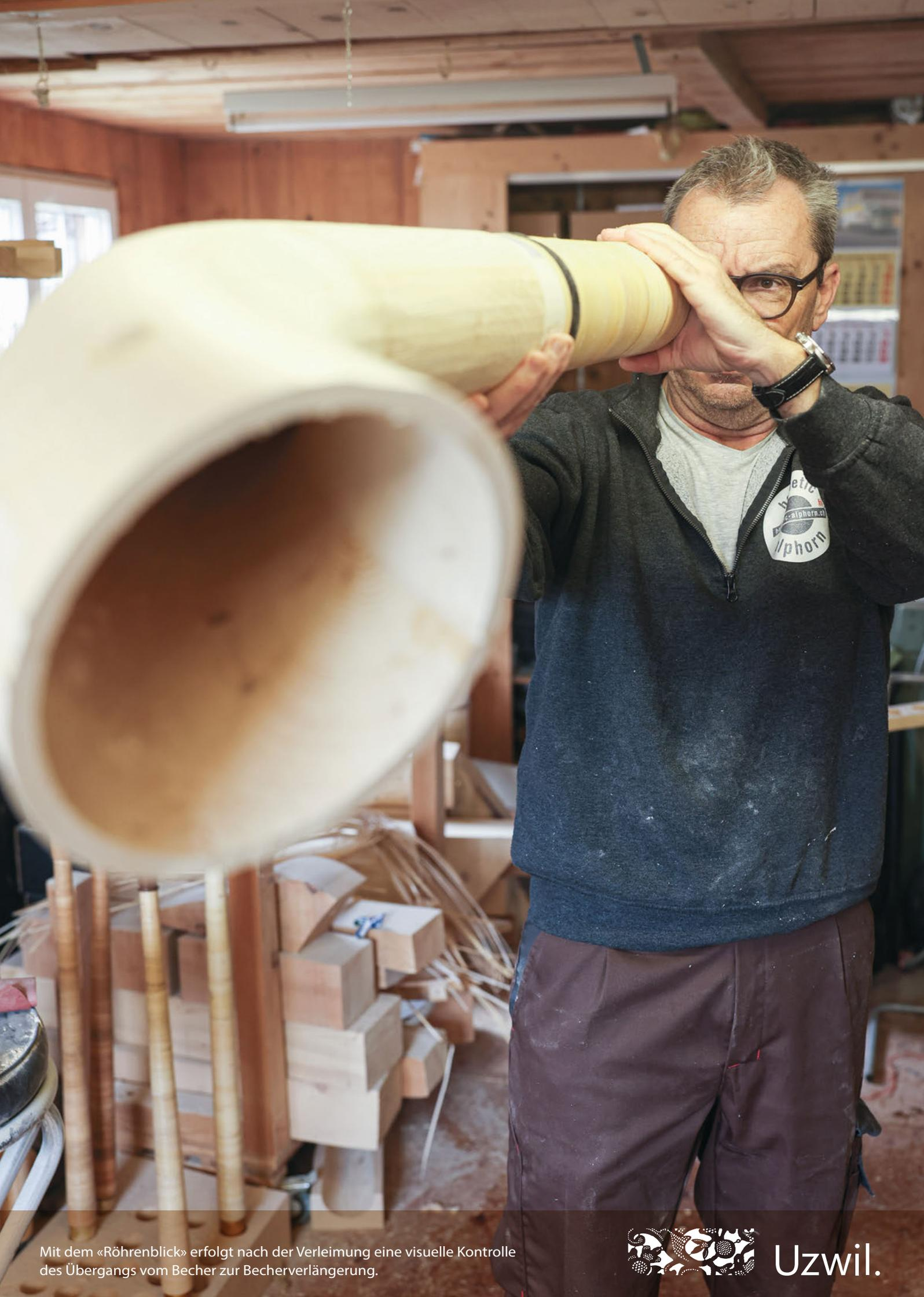
Mit dem «Röhrenblick» erfolgt nach der Verleimung eine visuelle Kontrolle des Übergangs vom Becher zur Becherverlängerung.
