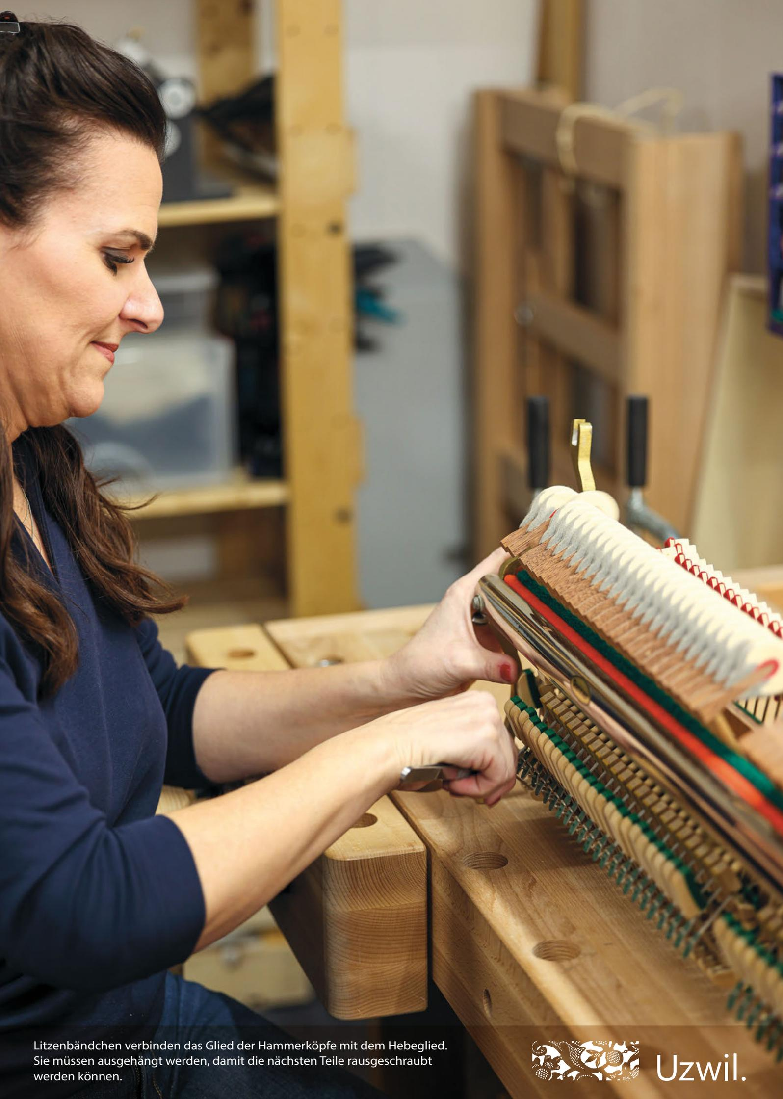
Litzenbändchen verbinden das Glied der Hammerköpfe mit dem Hebeglied. Sie müssen ausgehängt werden, damit die nächsten Teile rausgeschraubt werden können.
