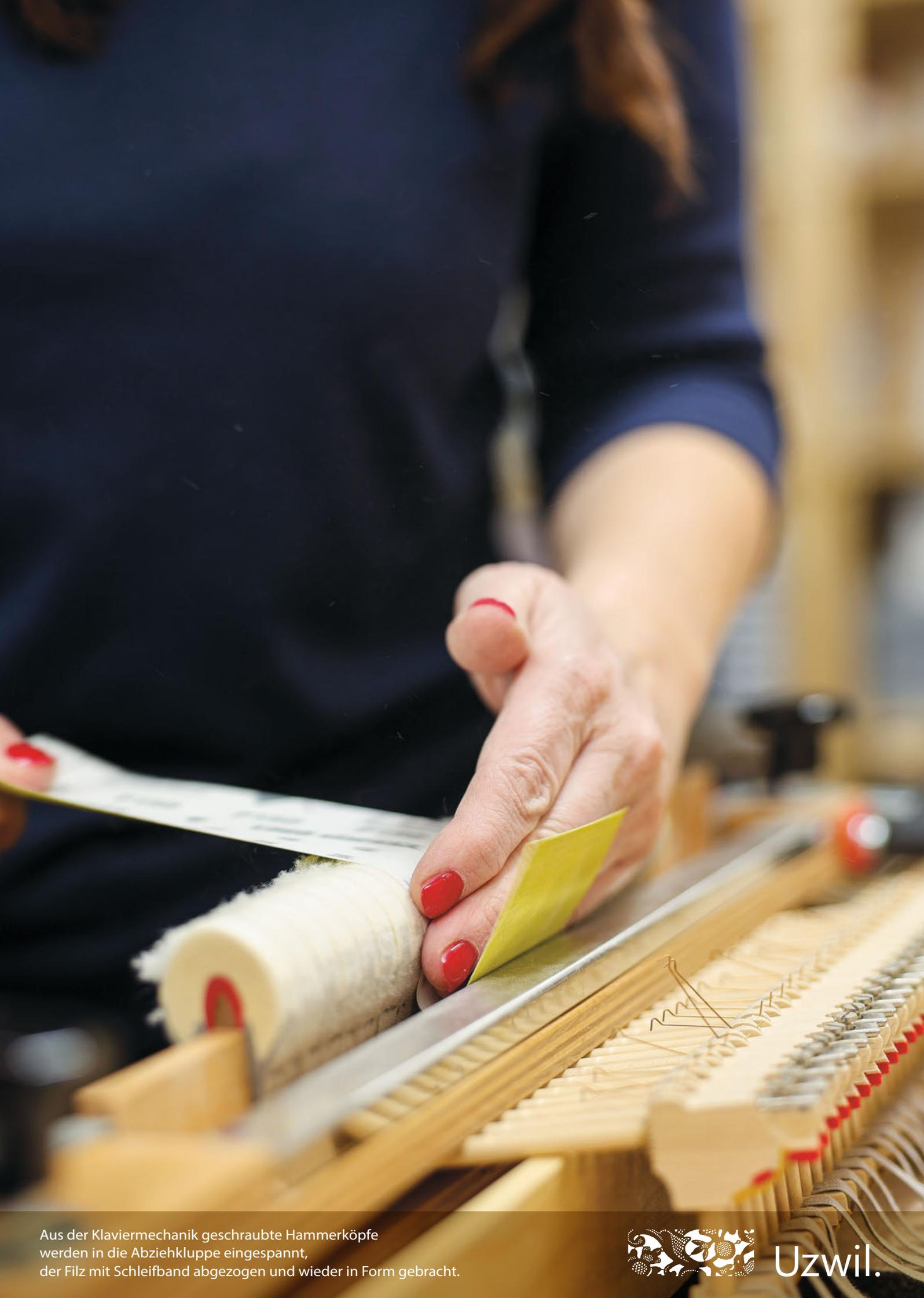
Aus der Klaviermechanik geschraubte Hammerköpfe werden in die Abziehkuppe eingespannt, der Filz mit Schleifband abgezogen und wieder in Form gebracht.
