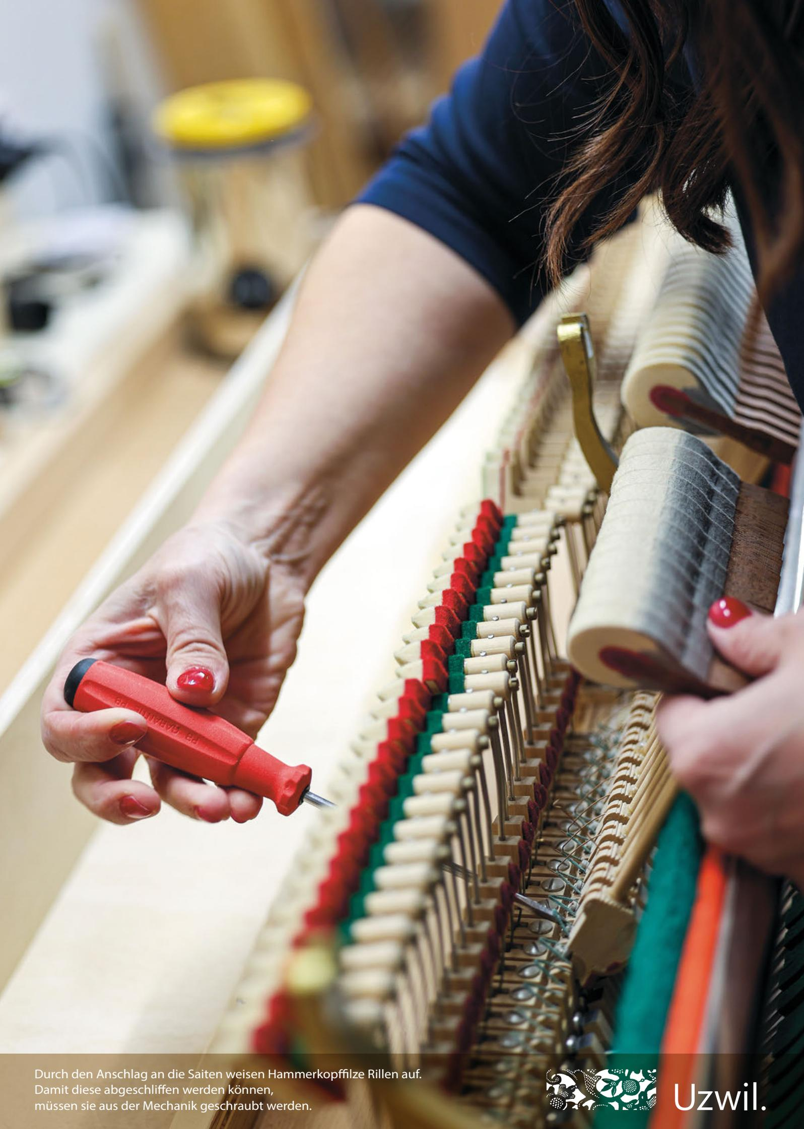
Durch den Anschlag an die Saiten weisen Hammerkopffilze Rillen auf. Damit diese abgeschliffen werden können, müssen sie aus der Mechanik geschraubt werden.
